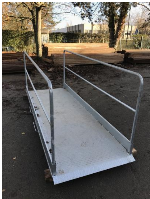
Passerelles 3,00 m * 1,00 m avec rebords de 15 cm de haut et barrières en acier galvanisé.
