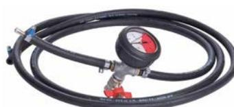
Manomètre avec raccord compresseur pour les diamètres > 200 mm.
