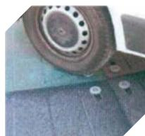
Pour les plaques de 20 mm d'épaisseur, charges admissibles jusqu'à 80 tonnes/m<sup>2</sup>.
